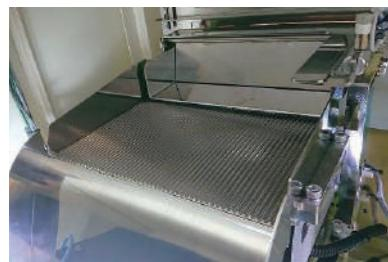
平トラフと溝トラフを組み合わせた2段トラフ方式により、ペレットの重なりが減り、落下姿勢も安定。
