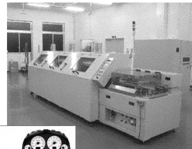
コックピットモジュール コネクタ類半田付け装置
