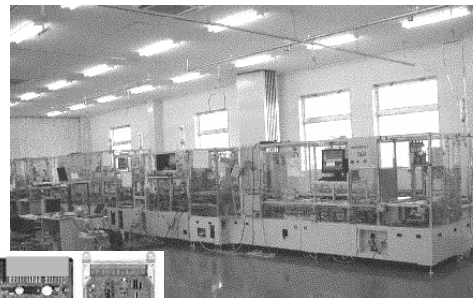
ECU・SRSセンサー 組立装置／検査装置
